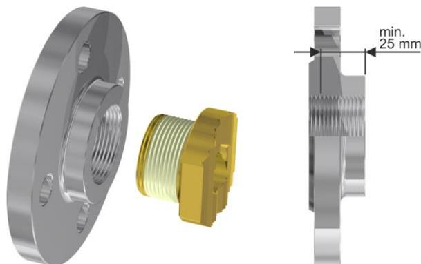
**Observação:** A profundidade de rosca do flange roscado ou do adaptador de conexão deve ser de, pelo menos, 25 mm.
