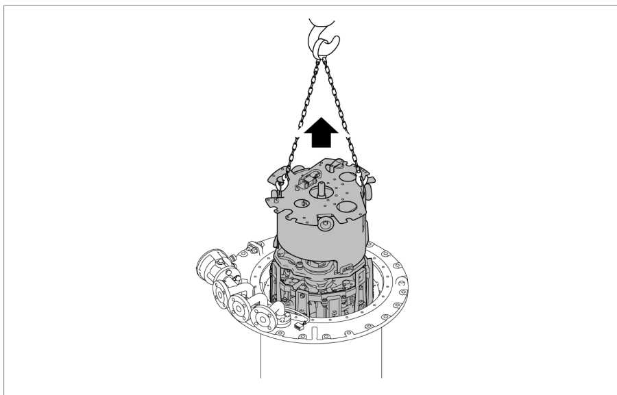
Figura 108: Suspender o corpo insertável da chave de carga
