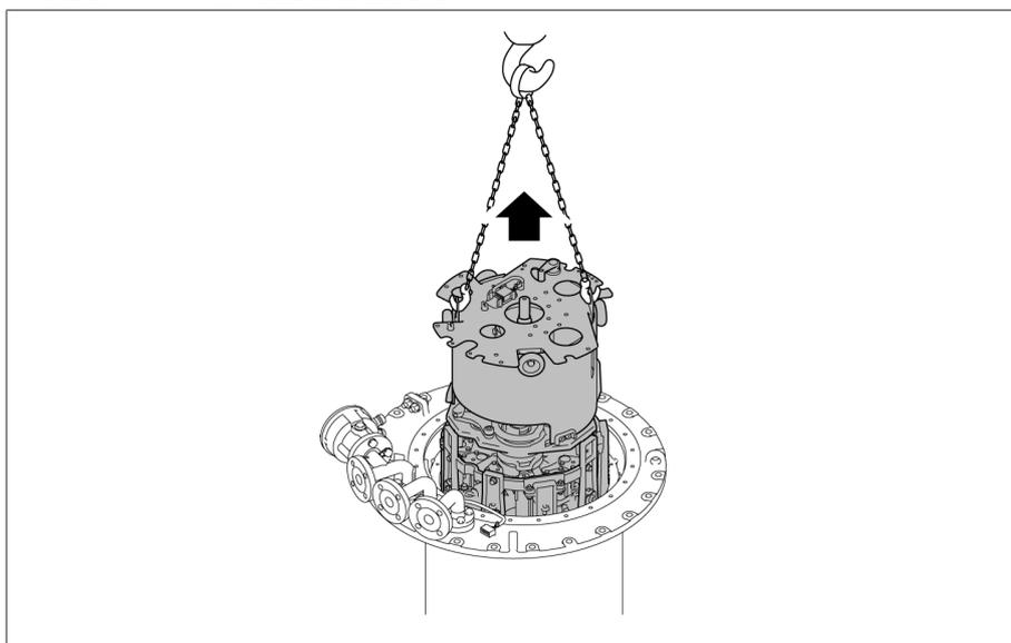
插图 58: 吊出切换开关芯子
