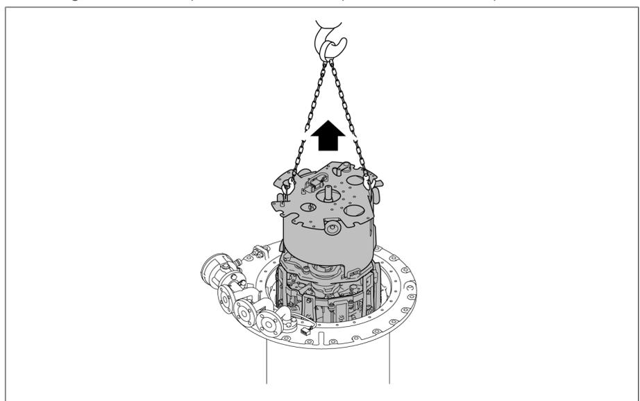
Figura 152: Extracción del cuerpo insertable del ruptor
